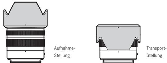
Objektive für die Leica TL2 werden mit optimal abgestimmten Gegenlichtblenden ausgeliefert. Sie lassen sich dank ihres symmetrischen Bajonetts ebenso einfach in Aufnahmestellung, sowie zur platzsparenden Aufbewahrung umgekehrt aufsetzen. Gegenlichtblenden vermindern Streulicht und Reflexe sowie Beschädigungen und Verschmutzungen der Frontlinse.
