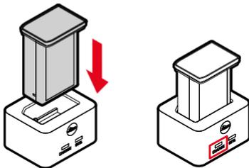
Der korrekte Ladevorgang wird durch die Status-LED angezeigt.
