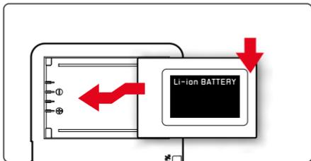
Der korrekte Ladevorgang wird durch die grün blinkende Status-LED angezeigt. Wenn sie dauerhaft leuchtet, ist der Akku vollständig aufgeladen.
