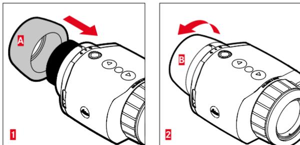
Para usarlo como dispositivo manual/monocular (sin mira telescópica), debe montarse la copa del ocular suministrada.
