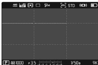
3,2" TFT LCD, 1080 x 720 píxeles, aprox. 2 332 800 puntos (dots), pantalla táctil
