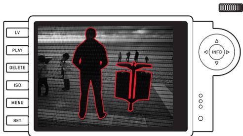
可在徠卡M的實時取景模式下於顯示幕上標示最佳銳利主題成像部位，以利辨識。
