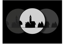
Индивидуальная настройка расстояния между глазами достигается сгибом по шарнирной оси. При правильной настройке расстояния между зрачками поля зрения справа и слева сливаются в единое изображение круглой формы.
