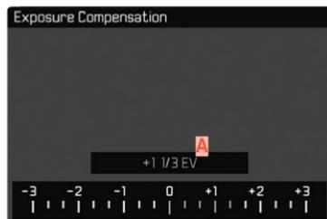
**A** A Valor de compensación configurado (si la marca se encuentra en 0 = desactivado)
