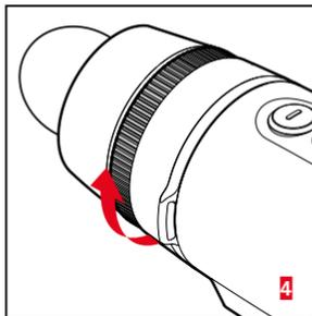
Zur Verwendung als Handgerät/Monokular (ohne Zielfernrohr) muss die mitgelieferte Augenmuschel angebracht werden.
