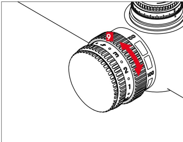
Bei höheren Vergrößerungen müssen die Abweichungen jedoch berücksichtigt werden. Daher besitzen Zielfernrohre mit Vergrößerungsbereichen, die über eine Maximalvergrößerung von 12-fach hinausgehen, einen Parallaxenausgleich.
