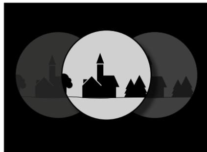
Los prismáticos se pueden ajustar a la separación ocular individual, doblando por su eje articulado. Cuando el ajuste de distancia interpupilar es correcto, los campos visuales derecho e izquierdo se fusionan en una única imagen circular.
