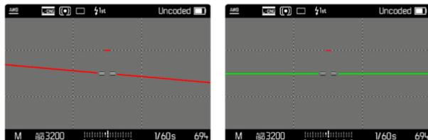
画像中央部から左右にのびている緑色の線は上下の傾斜がないことを示します。前後に傾いている場合は画像中央部に白線が表示され、その上側または下側に短い赤線が表示されます。
