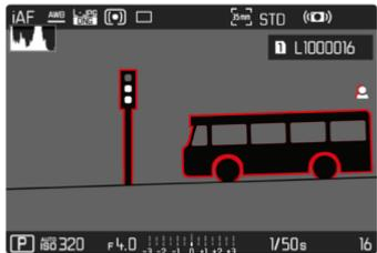
对焦峰值启用状态下，在图像内右侧会出现
