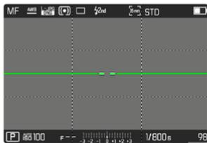
在显示屏画面中，图像中央的左右两边的两条长线代表横轴。
