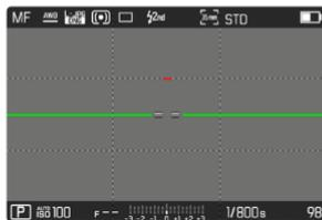
对于纵轴，图像中央左右两边的两条绿色双线直接表示零位。当相机倾斜时，它们是白色的，此外其上方或下方会出现一条红色短线。
