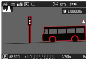
对焦峰值启用状态下, 在图像内右侧会出现
