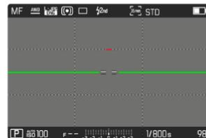
画像中央部から左右にのびている緑色の線は上下の傾斜がないことを示します。前後に傾いている場合は画像中央部に白線が表示され、その上側または下側に短い赤線が表示されます。
