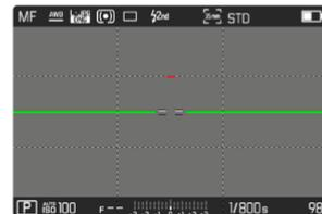
Per l'asse longitudinale, la posizione zero è indicata da due doppie linee verdi immediatamente a sinistra e a destra del centro dell'immagine. Se la fotocamera è inclinata, sono bianche. Inoltre, al di sopra o al di sotto di essi appare anche un trattino breve di colore rosso.
