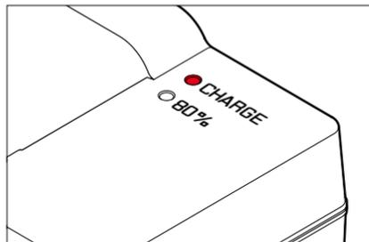
Il LED di stato segnala il corretto processo di ricarica.
