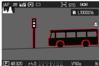
Cuando el focus peaking está activado, aparece una indicación en la parte derecha de la pantalla
