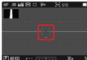
Para el eje longitudinal, dos rayas dobles de color verde, directamente a la izquierda y la derecha del centro de imagen, indican la posición cero. Al inclinar la cámara, se vuelven blancas, y arriba o abajo aparece además una raya corta de color rojo.
