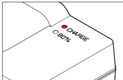
El proceso de carga correcto se indica mediante el LED de estado.
