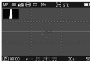
El eje transversal se muestra en la imagen del monitor mediante dos rayas largas a la izquierda y derecha del centro de la imagen.
