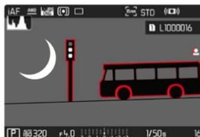
Cuando el focus peaking está activado, aparecerá una indicación en la parte derecha de la pantalla
