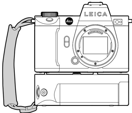
Para fotografiar en formato vertical durante un periodo de tiempo prolongado (por ejemplo, cuando realice retratos) puede fijar la correa de transporte al ojal de transporte derecho de la cámara y al de la empuñadura. De este modo, la cámara se mantendrá fija en la posición adecuada. Para colocar de la correa de transporte v. pág. 30.
