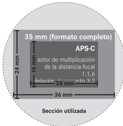
Configuración de fábrica: **35 mm**
