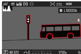
Cuando el focus peaking está activado, aparece una indicación en la parte derecha de la pantalla
