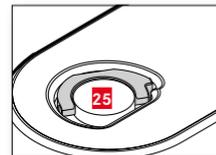
\* Lensa Leica M yang dilengkapi attachment jendela bidik akan menutupi sensor kecerahan. Informasi tentang cara kerja menggunakan perlengkapan tersebut dan lensa lainnya dapat dilihat pada bagian "Tampilan (jendela bidik)", dan "Lensa Leica M".
