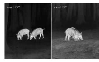
Netteté, précision et contraste d'image uniques grâce au système Leica Image Optimization (LIO $^{\text{TM}}$ ) avec 640 x 512 Pixel pour une taille de 12  $\mu$ m par Pixel.
