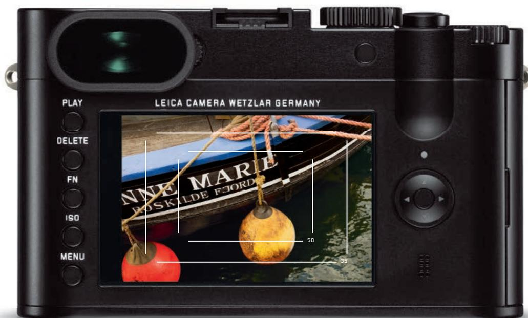
ボタン操作ひとつで簡単に撮影される範囲を変更できるフレームセレクト機能を搭載。
