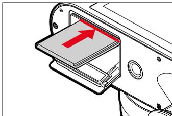
→ メモリーカードの接点をモニター側に向け、カチッと音がするまで押し込む。
