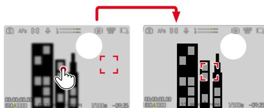
測距点/AFフレームをモニターの中央に移動させるには
