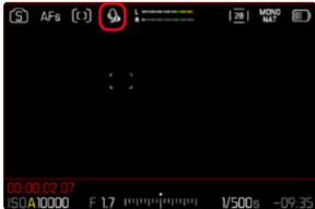
如要使用外置USB麦克风，须通过菜单激活该功能。如果启动了USB麦克风功能，系统会自动在内置麦克风或连接的外置麦克风之间切换。
