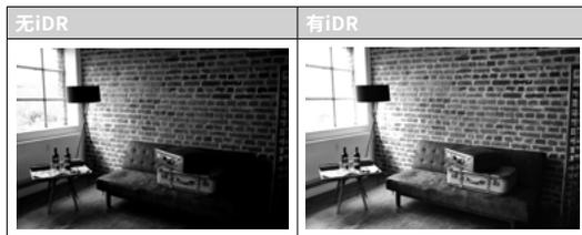
可以预先确定是否以及在多大程度上对暗区进行这种优化（**高**，**标准**，**低**，**关**）。当设置为**自动**时，相机会根据主体的对比度范围自动选择合适的设置。除此设置外，效果还取决于曝光设置。当与低ISO值和高快门速度相结合时，该功能会具有最强的效果。使用较高的ISO值和/或较慢的快门速度时，效果会变弱。
