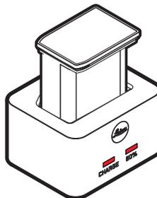
El proceso de carga correcto se indica mediante el LED de estado.
