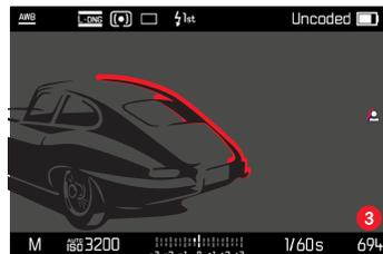
Cuando el focus peaking está activado, aparece una indicación en la parte derecha de la pantalla
