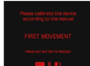
→ Gire el dispositivo en sentido antihorario alrededor de su eje vertical dos veces en un lapso de 20 segundos.
