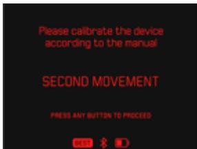
→ Gire el dispositivo en sentido antihorario alrededor de su eje horizontal dos veces en un lapso de 20 segundos.
