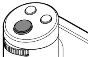
Le déclencheur fonctionne en deux temps.
