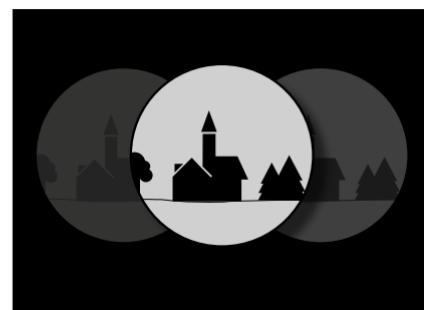
Durch Knicken des Fernglases um die Gelenkachse wird der persönliche Augenabstand eingestellt. Bei korrektem Augenabstand verschmelzen rechtes und linkes Sehfeld zu einem kreisrunden Bild.
