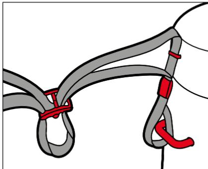
Die Okular-Schutzdeckel können am Tragriemen befestigt werden. Dies muss zusammen mit dem Anbringen des Tragriemens am Fernglas erfolgen.
