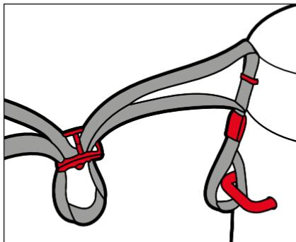
Las tapas protectoras del ocular se pueden fijar a la correa de transporte. Para ello, fijarla al mismo tiempo que se coloca la correa de transporte en los prismáticos.
