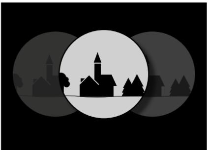
Los prismáticos se pueden ajustar a la separación ocular individual, doblando por su eje articulado. Cuando el ajuste de distancia interpupilar es correcto, los campos visuales derecho e izquierdo se fusionan en una única imagen circular.
