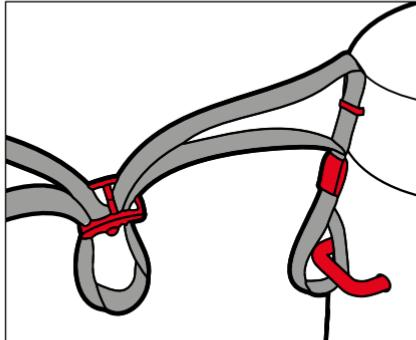
Las tapas protectoras del ocular se pueden fijar a la correa de transporte. Para ello, fíjala al mismo tiempo que se coloca la correa de transporte en los prismáticos.
