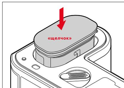
→ ввести аккумулятор в отсек желобком в сторону дисплея, пока он ощутимо и слышимо не зафиксируется
