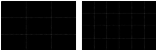
Доступны два варианта отображения сетки. Они разделяют поле изображения на следующее количество полей: 3 x 3 или 6 x 4.
