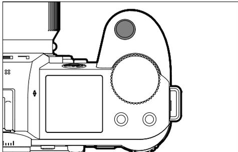
Кнопка спуска затвора имеет два уровня нажатия.
