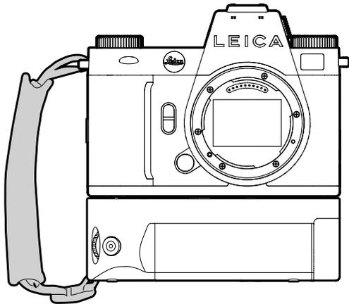
Для продолжительной съёмки в вертикальном формате (например, портретная съёмка) наплечный ремень можно альтернативно прикрепить к правой проушине для крепления ремня на камере и к проушине на рукоятке. Таким образом камера будет все время находиться в подходящем положении. Для крепления наплечного ремня см. стр. 34.
