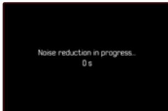
До тех пор, пока эта функция активна, подавление шумов будет при определённых условиях проводиться всегда. К этому относятся снимки с функцией «Г», а также снимки с длительной выдержкой, когда выдержка  $\geq 8$  с.
