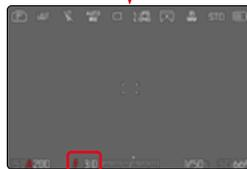
– Предварительный просмотр для текущего значения диафрагмы (глубины резкости)
