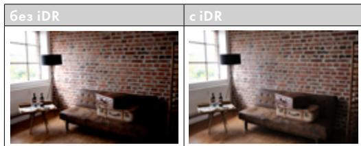
Насколько активно должна производиться оптимизация тёмных участков, и должна ли она проводиться вообще, может быть установлено заранее (**Высок**, **Стандартный**, **Низк**, **Выкл**). При установке **Авто** камера выбирает подходящую настройку в зависимости от контрастности сюжета автоматически.
