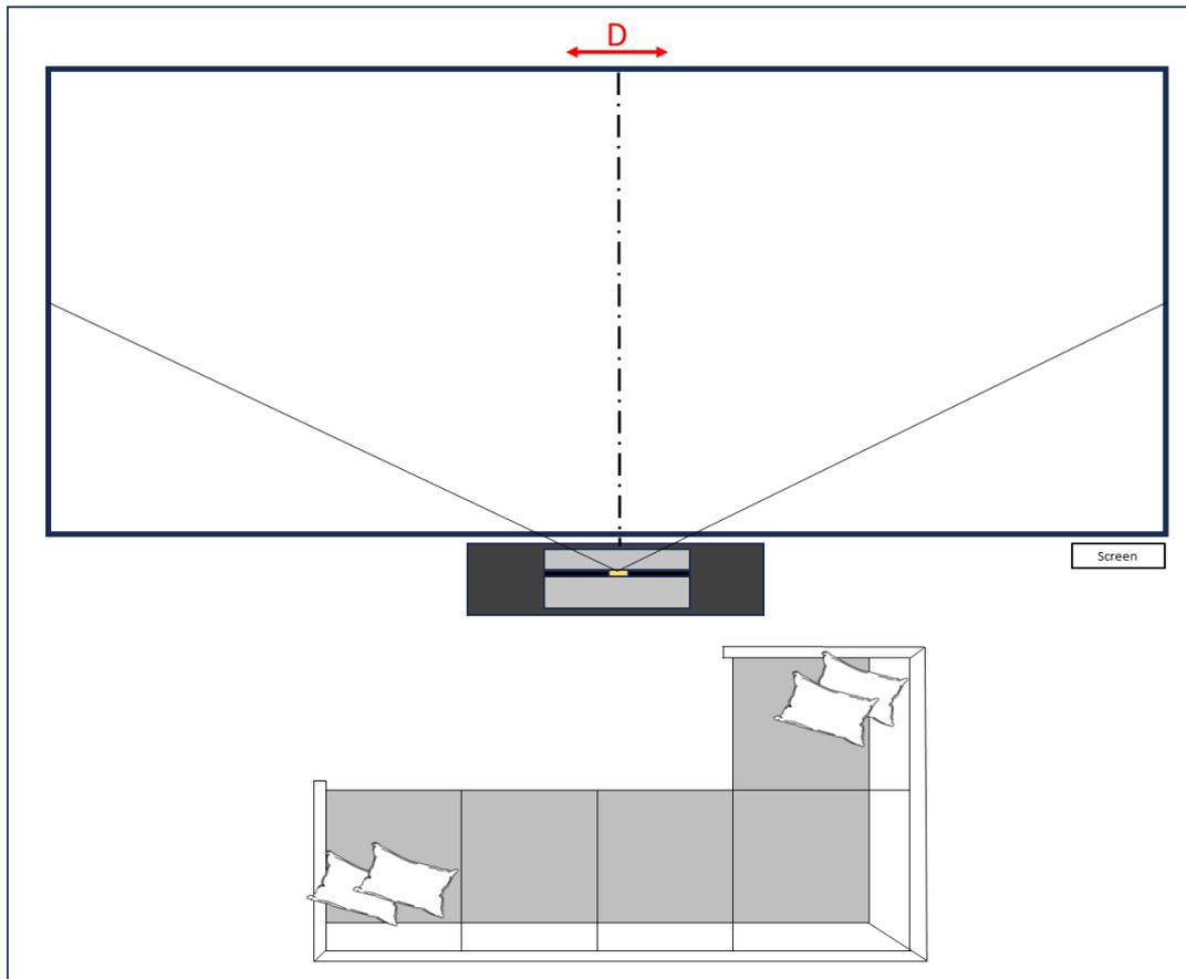
Maximale Verschiebung zwischen Projektor und Bild auf der Leinwand.
