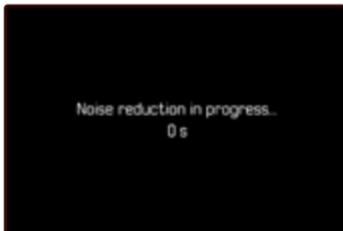
Tant que la fonction est activée, la réduction du bruit est systématiquement effectuée dans certaines conditions. Il s'agit notamment des prises de vue avec la fonction T et des expositions prolongées avec des vitesses d'obturation  $\geq 8$  s.
