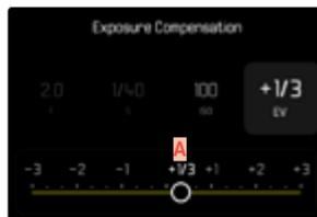
**A** 設定した補正值 (0=補正機能オフ)
