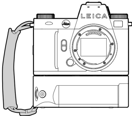
継続してポートレートなどの縦写真を撮影する場合は、キャリングストラップをカメラのストラップ取り付け部とハンドグリップのストラップ取り付け部に取り付けることもできます。キャリングストラップの取り付け方に関しては、p.34をご参照ください。
