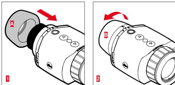
Pour utiliser l'appareil comme appareil indépendant/monoculaire (sans lunette de visée), il est nécessaire d'installer la bonnette fournie.
