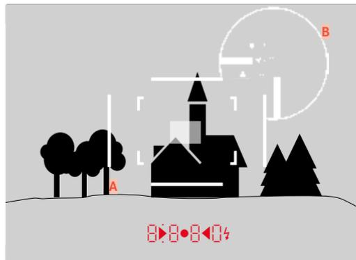
Todas as captações e posições de moldura luminosa em relação à distância focal de 50 mm
