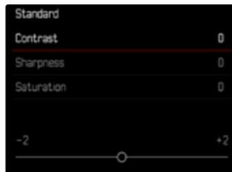
A definição dos diferentes pontos de menu é realizada através de uma barra de definição na área inferior da visualização.
