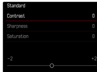
Die Einstellung der einzelnen Menüpunkte erfolgt über einen Einstellbalken im unteren Bereich der Anzeige.
