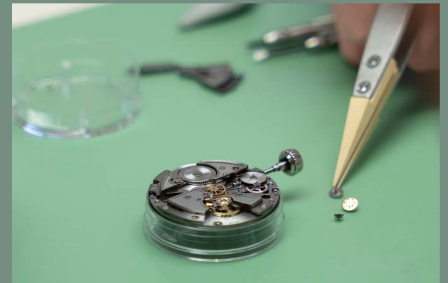
Le calibre Leica LA-3001 (à droite) a été développé en étroite collaboration avec le spécialiste suisse de l'horlogerie Chronode.
