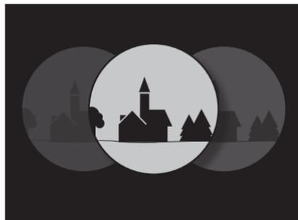
Per una regolazione personalizzata della distanza interpupillare, flettere il binocolo lungo l'asse snodato. Quando la distanza oculare è corretta, il campo visivo a destra e a sinistra si fondono in un'unica immagine circolare.
