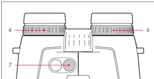
4. Non appena compare il collimatore, e continuando ad osservare con entrambi gli occhi, regolare la ghiera di regolazione diottrica **7** di destra, puntino rosso) in modo che il collimatore sia a fuoco nell'ottica di destra.
