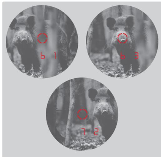
Con Leica Geovid HD-B/HD-R è possibile eseguire misurazioni anche a ciclo continuo (modalità Scan). Al secondo azionamento, mantenere premuto il pulsante principale/di scatto **I**. Dopo circa 2,5 secondi, il dispositivo entra in modalità Scan ed esegue misurazioni a ciclo continuo. La modalità Scan è riconoscibile dall'alternarsi delle visualizzazioni sul display.
