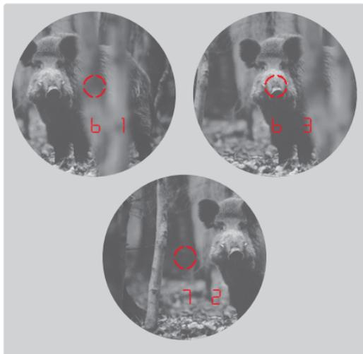
Met de Leica Geovid HD-B/HD-R kan ook permanent (scanmodus) worden gemeten: Houd de hoofd-/ontspanknop **1** bij de tweede bediening ingedrukt. Na circa 2,5 seconden gaat het toestel over naar de scanmodus en verricht dan permanent metingen. Dit herkent u aan de wisselende weergave:
