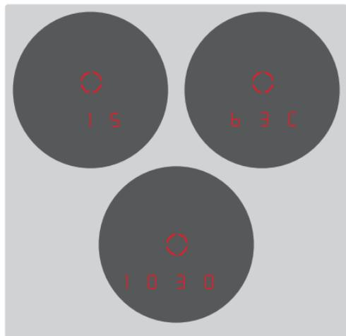
Per calcolare la posizione esatta del punto d'impatto (si veda anche il capitolo successivo), il binotelemetro Leica Geovid HD-B/HD-R rileva altri tre dati fondamentali durante la misurazione della distanza: l'inclinazione del dispositivo, la temperatura e la pressione atmosferica. I rispettivi valori possono essere visualizzati in qualsiasi momento.
