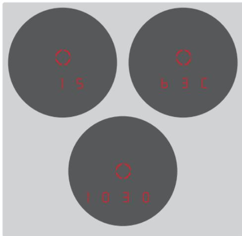
Для точного расчета точки попадания (см. следующий раздел) при измерении расстояния Leica Geovid HD-B/HD-R дополнительно определяет три важных параметра: наклон прибора, температуру и давление воздуха. Соответствующие значения могут быть отображены в любое время.
