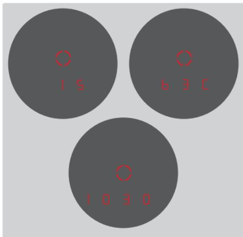
Voor de nauwkeurige berekening van het trefpunt (zie daartoe het volgende gedeelte) berekent de Leica Geovid HD-B/HD-R tijdens de afstandsmeting ook drie belangrijke gegevens: de neiging van het toestel, de temperatuur en de luchtdruk. De betreffende waarden kunt u altijd laten weergeven.
