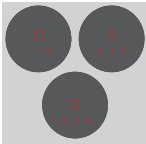
Pour le calcul précis du point d'impact (voir paragraphe suivant), les Leica Geovid HD-B/HD-R fournissent également, en même temps que la mesure de la distance, trois informations importantes : l'inclinaison de l'appareil, la température et la pression atmosphérique. Vous pouvez faire apparaître ces valeurs à tout moment.
