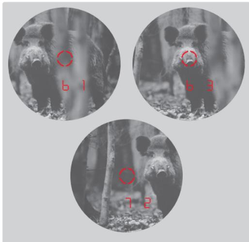
Mit dem Leica Geovid HD-B/HD-R kann auch im Dauerbetrieb (Scan-Betrieb) gemessen werden: Halten Sie die Haupt-/Auslösetaste **1** bei der 2. Betätigung gedrückt. Nach ca. 2,5 Sekunden schaltet sich das Gerät in den Scan-Betrieb und führt dann permanent Messungen durch. Zu erkennen ist dies an der wechselnden Anzeige: Nach jeweils ca. 0,5 Sekunden wird ein neuer Messwert ausgegeben. Der Scan-Betrieb ist besonders praktisch bei der Messung auf kleine und sich bewegende Ziele.
