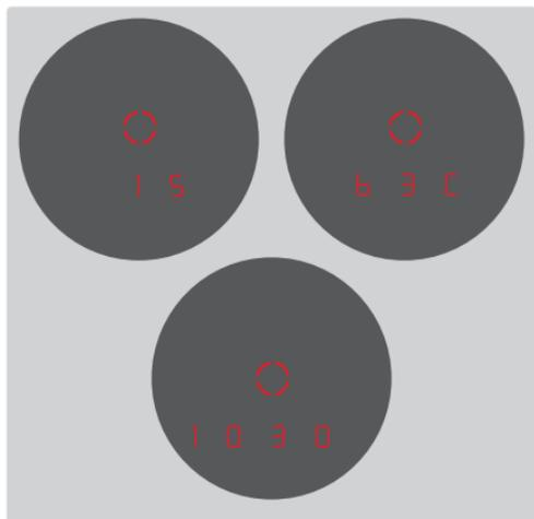
Para el cálculo exacto del punto de impacto (ver a este respecto la siguiente sección), el Leica Geovid HD-B/HD-R determina durante la medición de la distancia además tres informaciones adicionales importantes: la inclinación del aparato, la temperatura y la presión de aire. Los valores correspondientes se pueden visualizar en cualquier momento.
