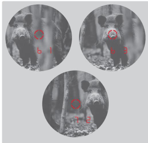
Con el Leica Geovid HD-B/HD-R también se puede medir en modo de funcionamiento permanente (modo exploración):
