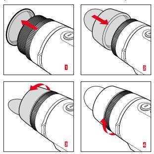
Per utilizzare il dispositivo come strumento manuale/monoculare da osservazione (senza cannocchiale da puntamento) occorre montare la conchiglia oculare fornita in dotazione.
