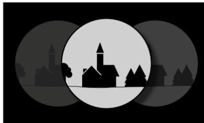
Per una regolazione personalizzata della distanza interpupillare, flettere il binocolo lungo l'asse snodato. Quando la distanza oculare è corretta, il campo visivo a destra e a sinistra si fondono in un'unica immagine circolare.
