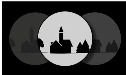
Los prismáticos se pueden ajustar a la separación ocular individual, doblando por su eje articulado. Cuando el ajuste de distancia interpupilar es correcto, los campos visuales derecho e izquierdo se fusionan en una única imagen circular.
