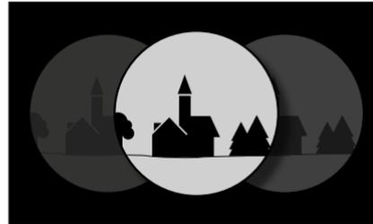
Durch Knicken des Fernglases um die Gelenkachse wird der persönliche Augenabstand eingestellt. Bei korrektem Augenabstand verschmelzen rechtes und linkes Sehfeld zu einem kreisrunden Bild.
